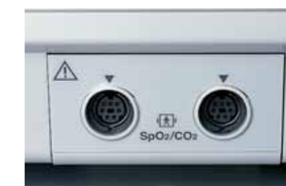
DSI Schnittstelle, QI-552V für SpO 2 und CO 2 (Foto) DSI/AUX Schnittstelle, QI-553V für SpO 2 oder CO 2 und AUX
